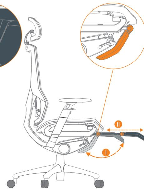
使用脚踏时：如图按紧按钮中间逆时针旋转 5°(向上)，即可松开按钮，将脚踏逆时针旋转到水平位置时，将被自动锁定；收回脚踏时，按紧按钮中间顺时针旋转 5°(向下)，即可松开按钮，将脚踏顺时针旋转，直到脚踏自动锁定，再将脚踏推回座垫下方
