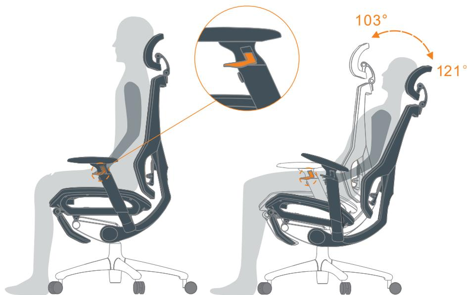
出厂前，已经对产品倾仰功能进行锁定；将拨片向上拨动一次（到位时，需要松开拨片），产品将处于解锁状态，产品即可倾仰；将拨片再向上拨动一次（到位时，需要松开拨片），产品的倾仰功能将被锁定。
